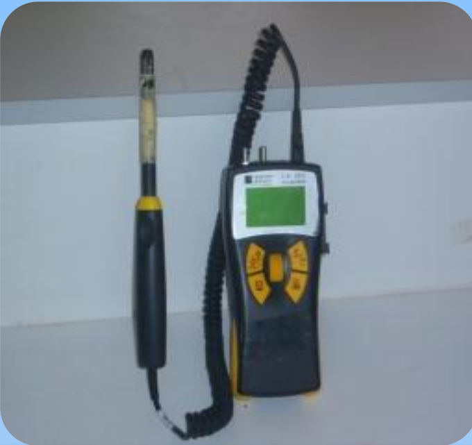
Sonde 2 pour la mesure de la T ° et HR
