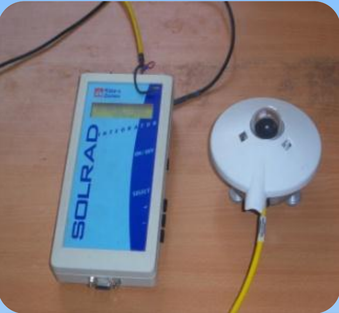
Solari mètre : mesure le rayonnement solaire
